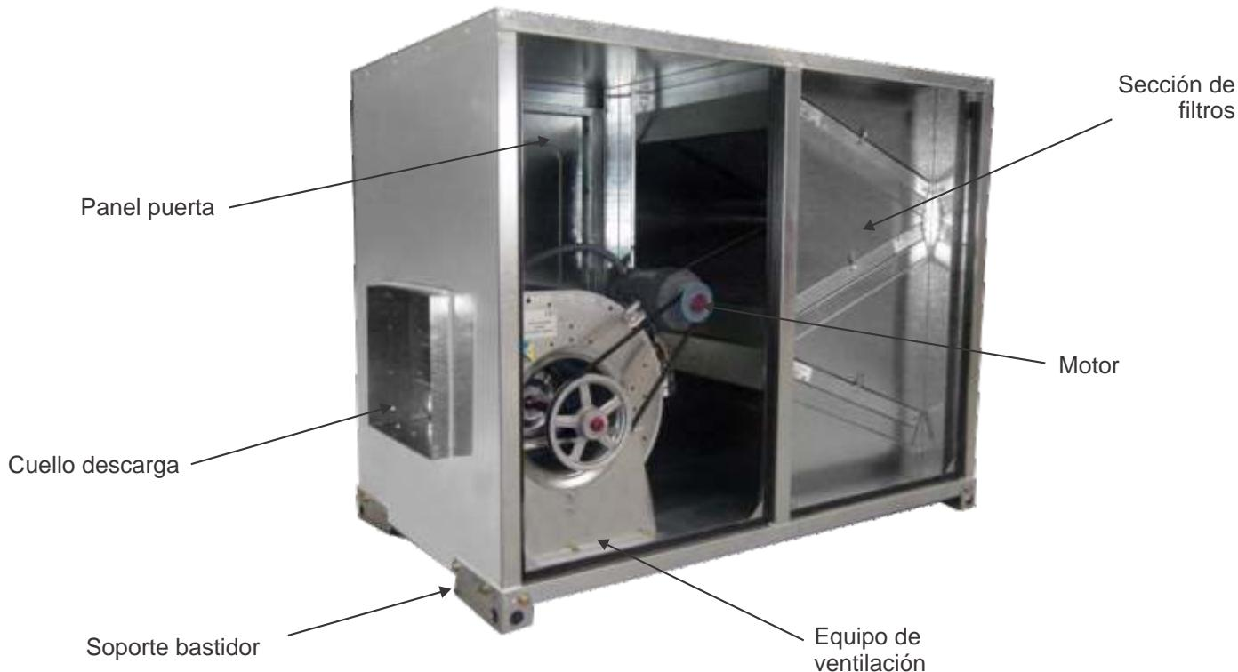
Gabinete hecho con paneles de diseño reforzado fabricados con lámina de acero galvanizada de grueso calibre que aportan rigidez al conjunto y minimizan problemas de vibraciones futuros. Los paneles pueden ser removidos para aportar una mayor flexibilidad en la instalación.
