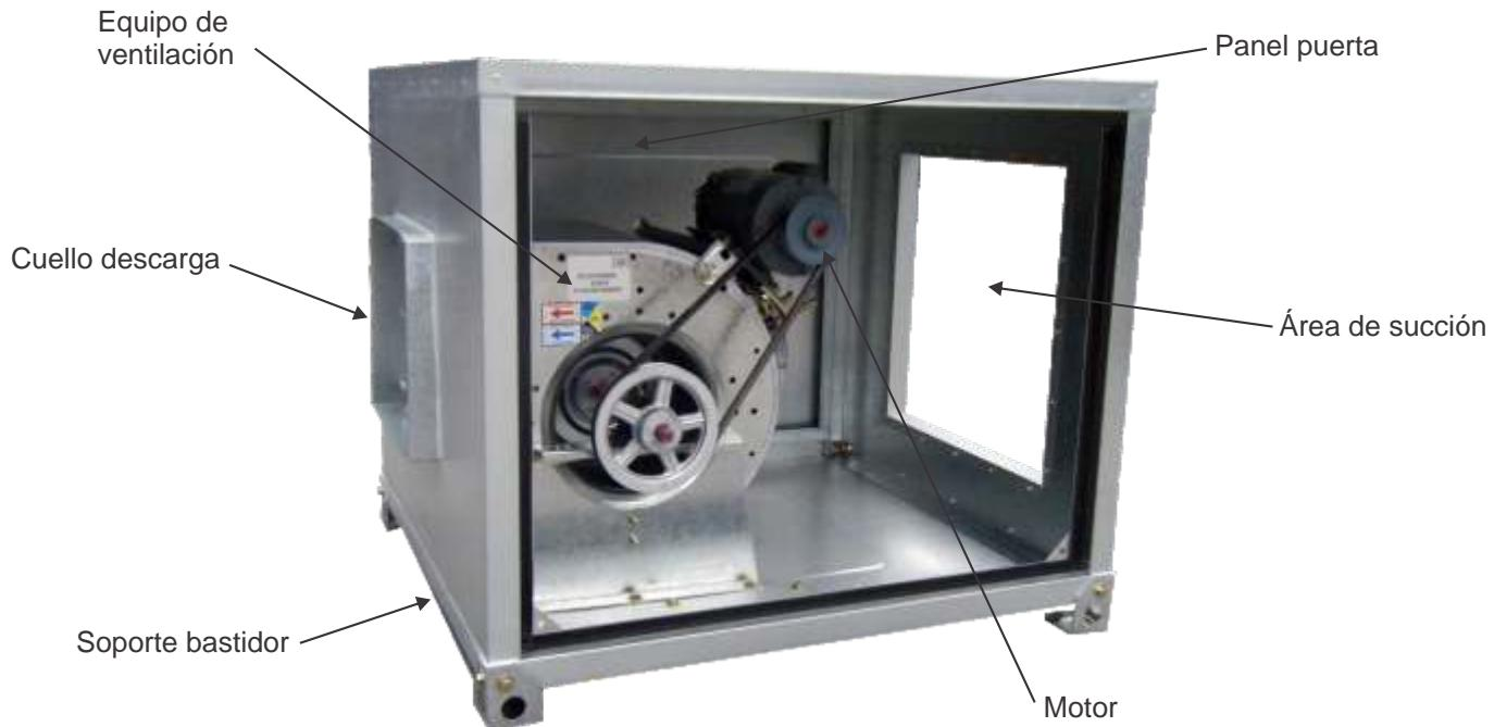
Gabinete hecho con paneles de diseño reforzado fabricados con lámina de acero galvanizada de grueso calibre que aportan rigidez al conjunto y minimizan problemas de vibraciones futuros. Los paneles pueden ser removidos para aportar una mayor flexibilidad en la instalación.
